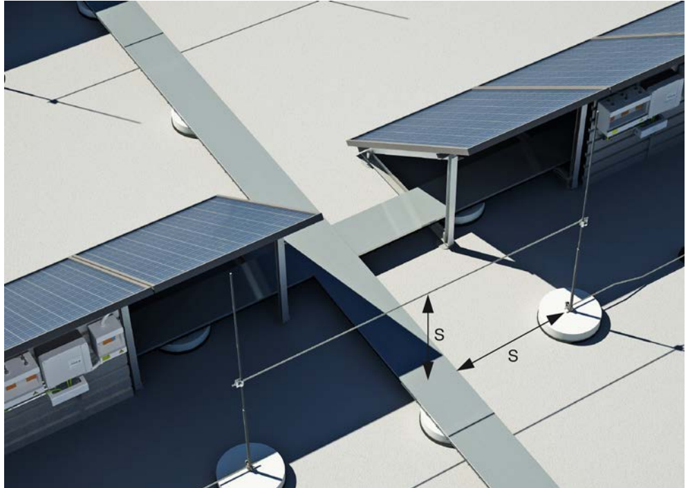
Bild 5: Trennungsabstand (Linie) zwischen Blitzschutzsystem und Leitungsführung
