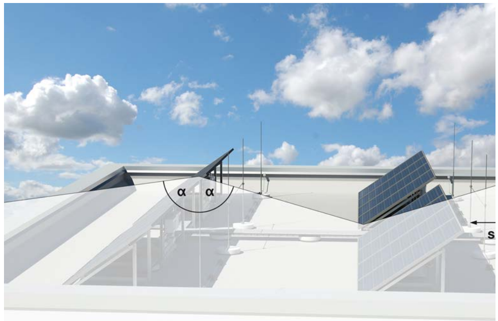
Bild 3: Schutzwinkel (·) an einer Fangstange
